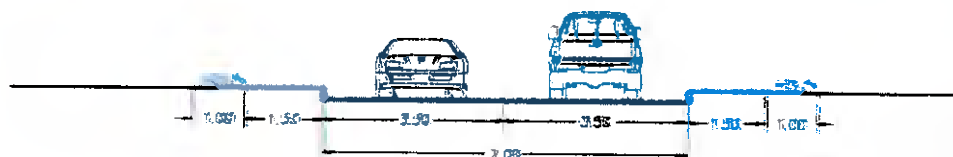
Figura 08: Caixa de via interna aos condomínios urbanísticos
